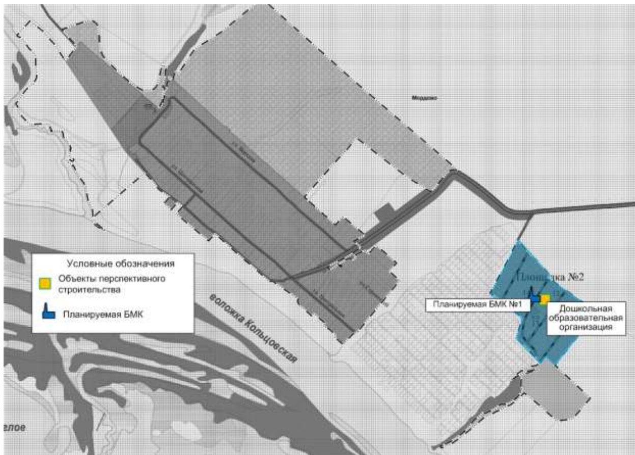
Рис. № 5 - Перспективные зоны теплоснабжения блочно-модульных источников тепловой энергии, планируемых к размещению на территории с. Мордово
